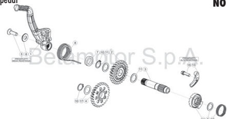
TAV.06 Avviamento a pedale - Kickstarter - Dé marrage à pedal - Pedalstart - Arranque a pedal NO 200cc
