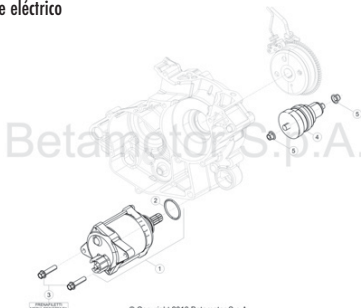
TAV.07 Avviamento elettrico - Electric starter - Démarrage électrique - Elektrischer start - Arranque eléctrico 200cc
