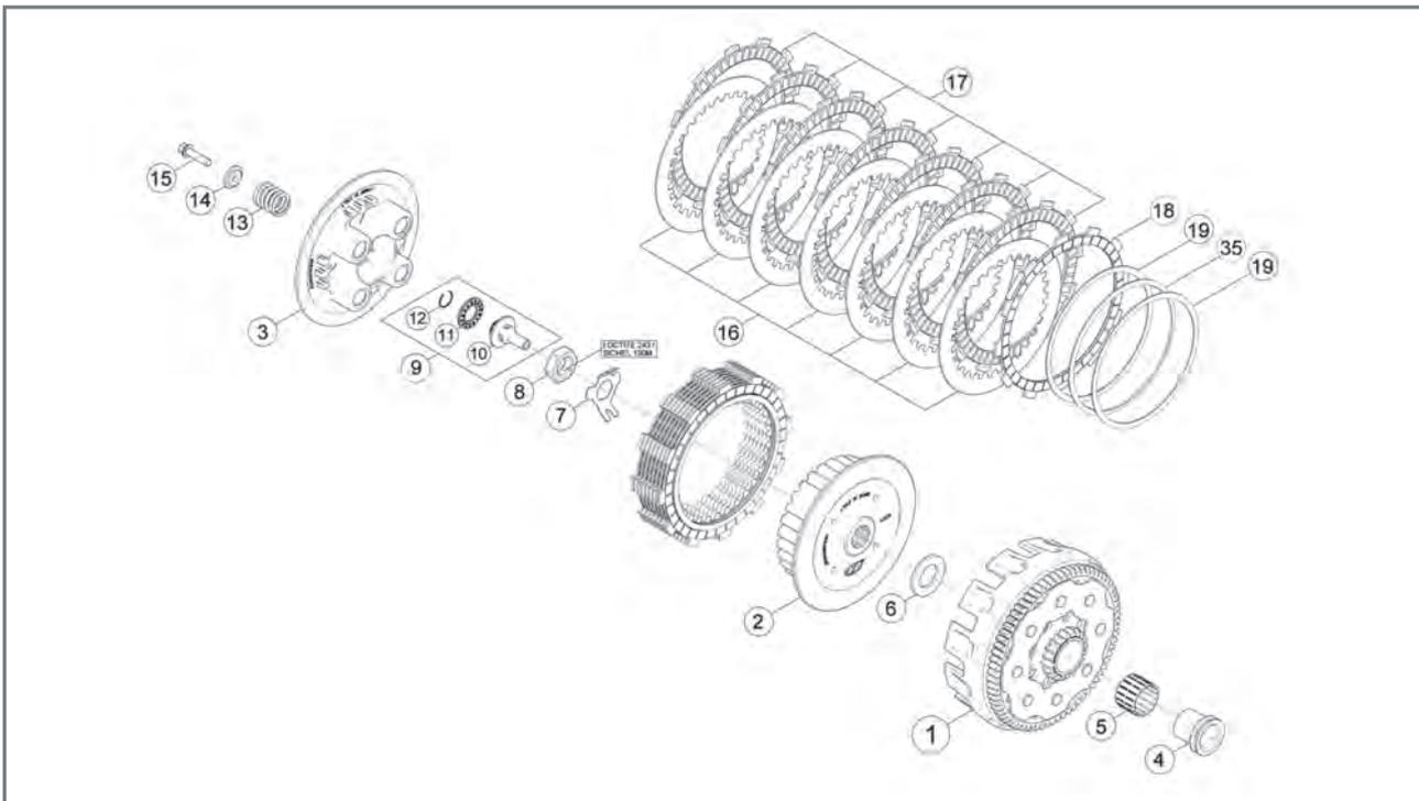
**EXPLODED VIEW OF CLUTCH UNIT** 1) Complete basket; 2) inner hub; 3) Clutch pressure cap; 4) Internal centre bearing; 5) Roller bearing 26x30x22; 6) Washer; 7) Safety washer; 8) Nut M18x1,5; 9) Overall thrust bearing; 10) Clutch body rod coupling; 11) Thrust bearing; 12) Circlip RB14; 13) Clutch spring; 14) Clutch spring retainer; 15) Screw M6x25; 16) Steel discs; 17) Friction discs; 18) special friction disc; 19) washer; 35) judder spring.
