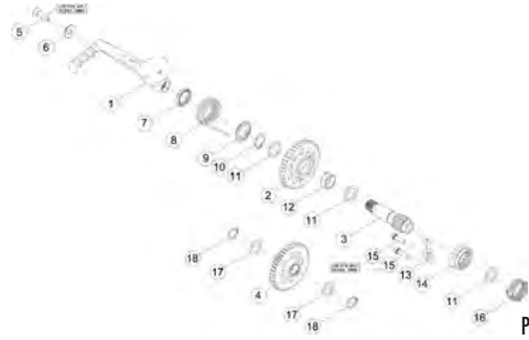
TAV.06 Avviamento a pedale - Kickstarter - Dé marrage à pedal - Pedalstart - Arranque a pedal
