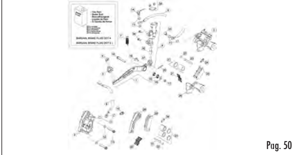
TAV.36 Impianto freni idraulici - Hydraulic brakes system - Installation des freins hydrauliques - Hidraulischebremse anlage - Instalación freno hidráulico
